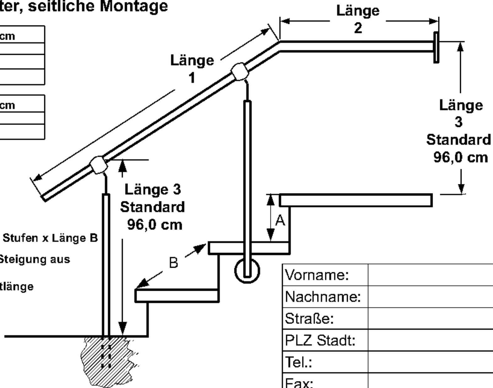
Länge 1 = Anzahl Stufen x Länge B
