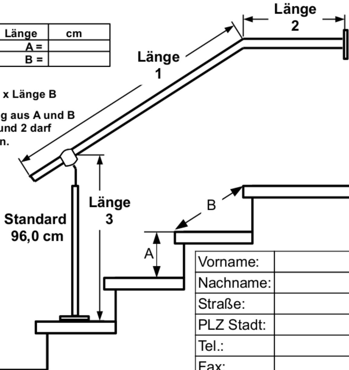
Länge 1 = Anzahl Stufen x Länge B
