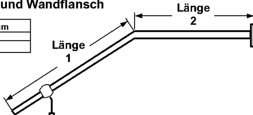
Länge 1 = Anzahl Stufen x Länge B
